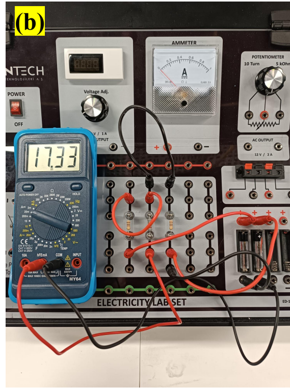
Şekil 3.8. İki Üreteçli iki ilmekli devre için akım okuması (a) I_{AB} , (b) I_{BC} , (c) I_{DB}
